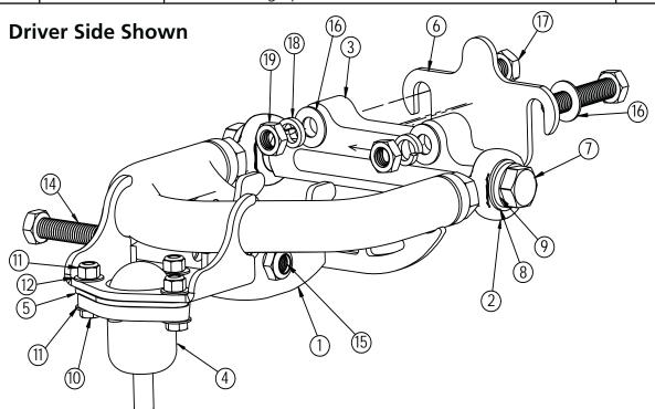
**NOTE:** DISCARD THE BALL JOINT NUT INCLUDED WITH THE BALL JOINT KIT. A NEW BALL JOINT NUT IS SUPPLIED IN THE HARDWARE KIT.
