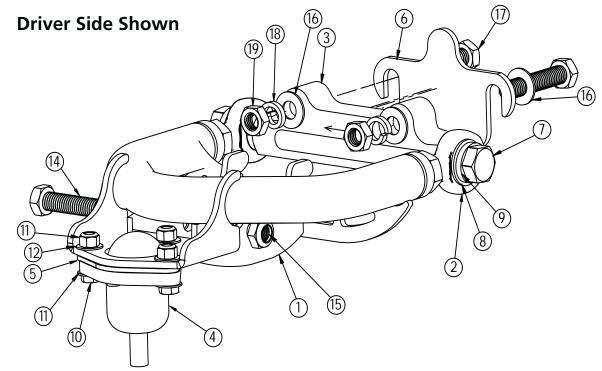
**NOTE:** DISCARD THE BALL JOINT NUT INCLUDED WITH THE BALL JOINT KIT. A NEW BALL JOINT NUT IS SUPPLIED IN THE HARDWARE KIT.
